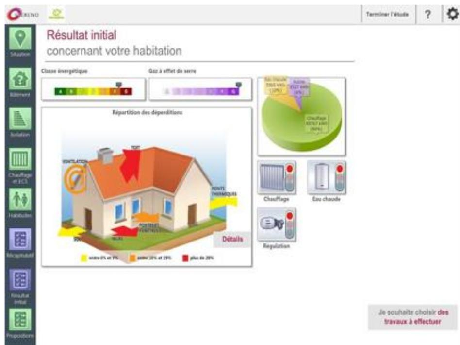
Dans le schéma ci-dessus, on peut voir que l'essentiel de la chaleur est perdue par le toit et par les murs. Or, avoir une maison performante nécessite de minimiser ces déperditions, ce qui peut être obtenu par la réalisation de travaux de rénovation énergétique cohérents, comme l'indique le schéma ci-dessous :
